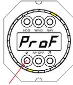
**Aktivieren des Profil Mode mit der linken Taste.** Damit wird auch der Autothrottle eingeschaltet.
