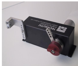
Aktuator für Gas oder Schaltung, nur bei mechanischen Motor-Steuerungen. Drehmoment 22 Nm (Zugkraft 400 N bei 80 mm Hub) Gew. 1,7kg
