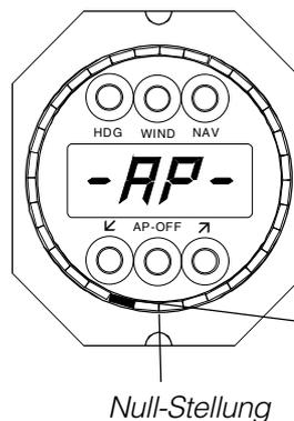
Die FADEC-BOX muss zum Konfigurieren am Strom und am CAN-Bus angeschlossen sein. Keine Aktuator-LED bedeutet "keine Verbindung mit der Box".
