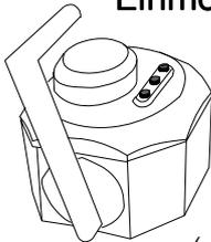
Der Status der Maschine wird durch die linke Diode (SERVO-LED) angezeigt, egal an welcher Seite der (einzige) Fahrhebel montiert ist.
