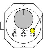
Dann wird die THR-Taste zwei Sekunden lang gedrückt, bis die THR-Diode zu blinken beginnt.
