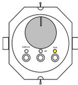
Ein kurzer Druck auf die THR-Taste aktiviert den (oder die) Fahrhebel. Die Maschine reagiert darauf sofort, entsprechend der Fahrhebelstellung, und die THR-LED (Fahrhebel-Diode, rechts) beginnt zu leuchten.
