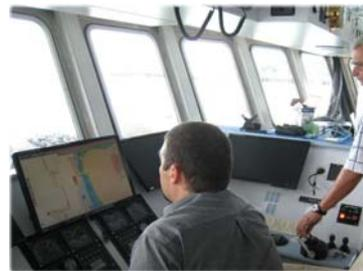
Bei Bedarf wechselt man in den sparsamen **Ankermode**. Dann liegt das Schiff an einer virtuellen Boje, am **Bug oder Heck**. Die Position der Boje kann mit dem Joystick in kleinen Schritten verändert werden. Die Thruster werden im Ankermode nicht benützt.
